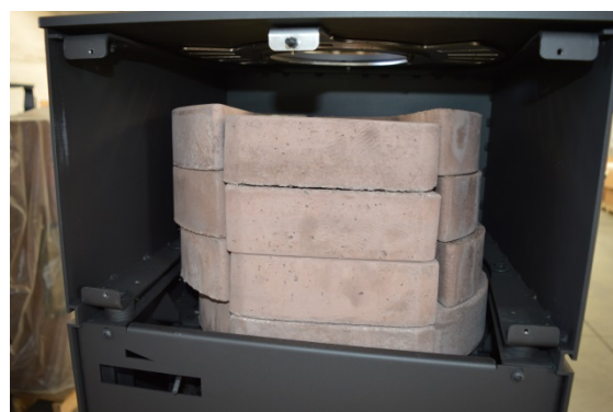
letzten vorderen Stein einlegen. Evtl. noch ausrichten, fertig.
