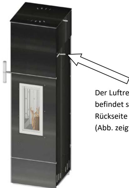
Der Luftregulierhebel befindet sich hier an der Rückseite des Ofens. (Abb. zeigt Santos plus)
