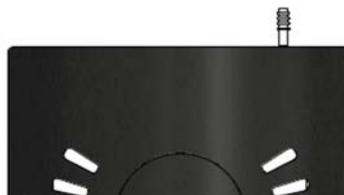
Lufthebel in Mittelstellung: Sekundärluft offen, Primärluft geschlossen
