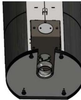
Um den Zuluftstutzen unten zu montieren, muss zuerst das Rückwandblech (Abb. Links) demontiert werden. Hierzu die vier Schrauben herausdrehen und die Rückwand wegnehmen.
