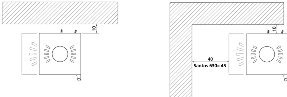
Im Strahlungsbereich der Front-Glasscheibe dürfen im Abstand von 80 cm keine brennbaren Bauteile und Möbel aufgestellt werden. Seitlich müssen im Strahlungsbereich der Glasscheibe 40 cm (bei Santos 630 45 cm) Abstand eingehalten werden.
