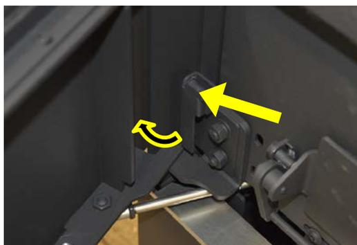
Beim Öffnen zum Aufhalten der Tür leicht oben gegen diesen Feststeller drücken. Hierdurch klappt der untere Teil heraus. Wenn dieser waagrecht steht, die Tür leicht schließen. Diese stoppt dann an diesem Feststeller. Zum Schließen der Tür diese nur kurz aufdrücken – der Feststeller klappt dann herunter und die Tür kann geschlossen werden.
