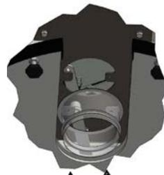
Dann wird der Zuluftstutzen unten am Ofen mit 2 Schrauben angeschraubt.
