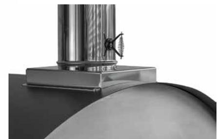
Wichtiges Detail: die Absperrklappe im Ofenrohr. Sie wird geschlossen, wenn das Feuer heruntergebrannt ist. Dadurch verbleibt die Hitze viel länger im Brennraum und kann effizienter genutzt werden.
